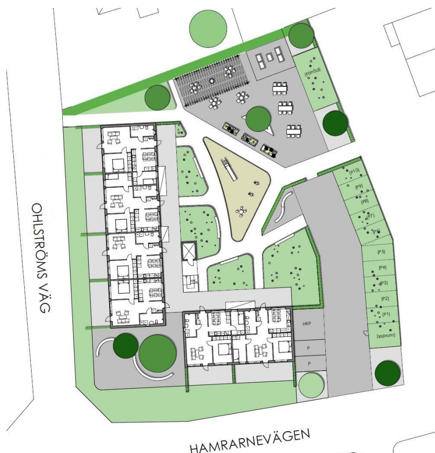
Situationsplan som visar förslag på bebyggelse och utformning av gårdsytor (Källa: Krook och Tjäder, 2017).
