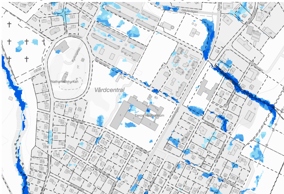
Figur 27: Skyfallskartering över planområdet som visar översvämningsdjup vid ett 100-års regn. Ljusblå färg indikerar ett djup på 0,1 – 0,3 meter och mörkblå ett djup på 0,3 – 0,5 meter
