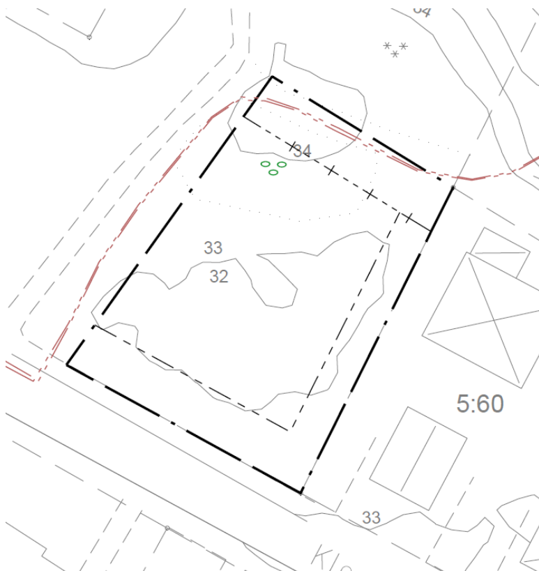
Figur 8. Röd linje symboliserar fjärrvärmeledningen.
