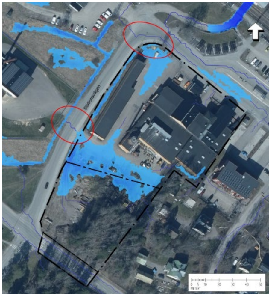
Figur 26: Planritning med projicering av tänkbara flödesvägar via Scalgo. I scenario leds en flödesväg mot diket väster om Stationsvägen förs det därefter vidare mot recipienten Fyrisån – Toboån.
