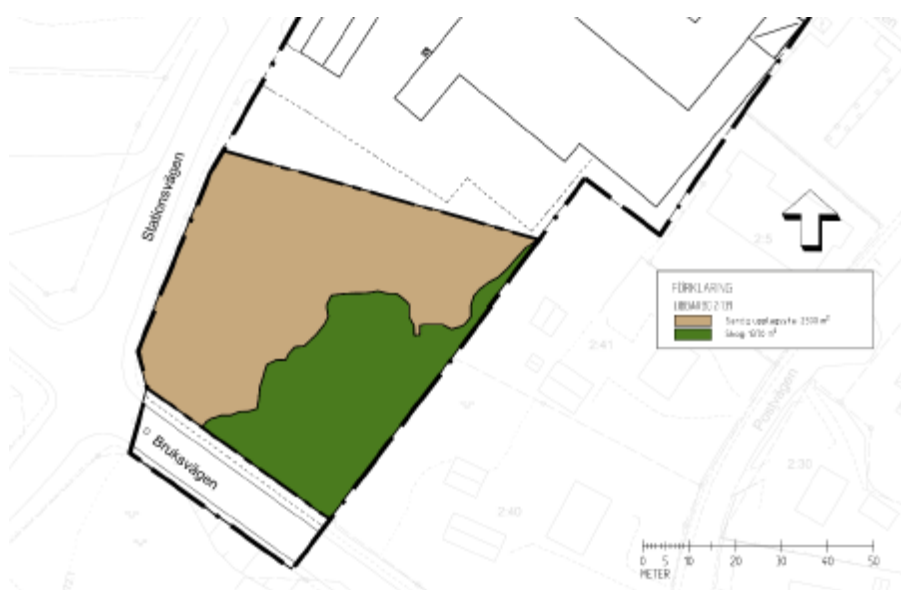
Figur 17: Planritning som visar utbredningen av två olika befintliga yttyper av skiljande karaktär och avrinningskoefficient inom fastighet Libbarbo 2:139
