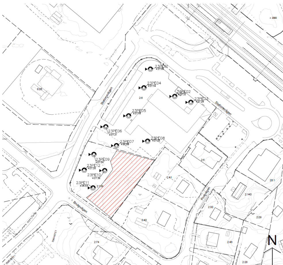
Figur 11: Provtagningspunkter inom undersökningsområdet. Cirkclar visar provpunkter och röd skrafferad yta visar område otillgängligt pga uppställning av maskiner, block eller tätare skog.
